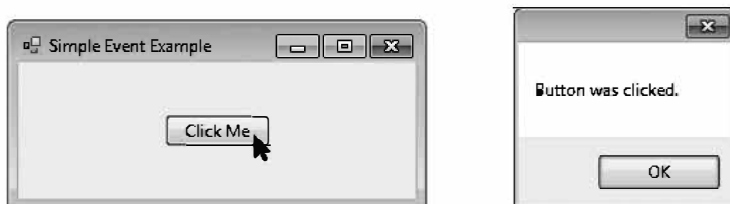
Ил. 14.5. Простой пример обработки события
